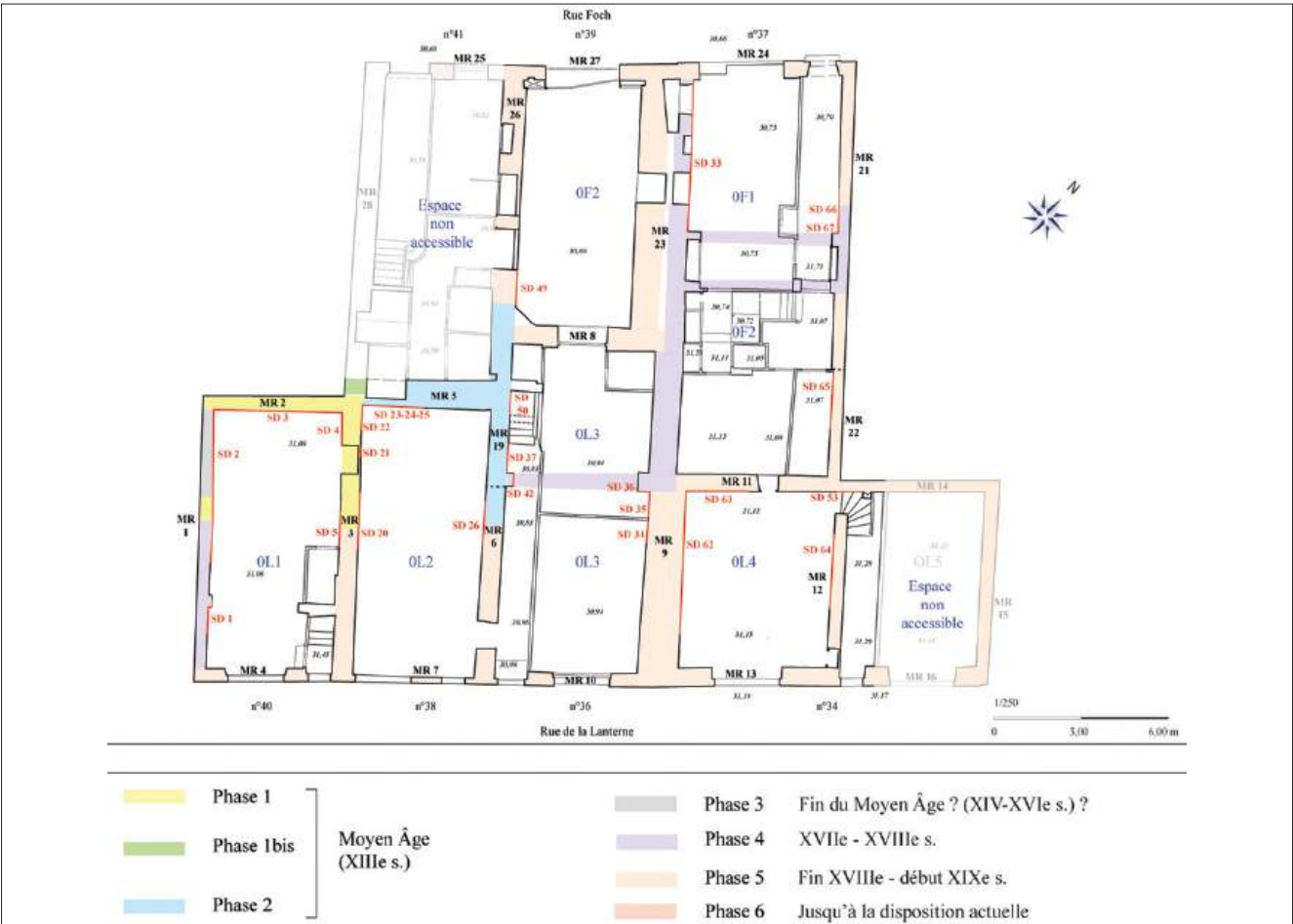
Figure 3 : Plan du rez-de-chaussée avec indication des phases de construction (plans : Outier architecture, DAO : SAD66).
