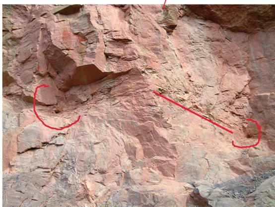
15 - Synclinal de Bouleternère. Carrière 5, dans les calcschistes versicolores. Sur le détail du front de taille, les traces du débitage à l'explosif (cl. au sol, M. Martzluff, cl. aérien P. Roca).
