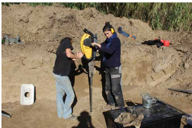
Figure 3 : Sondage à la tarière électrique (cliché : SAD.66).
