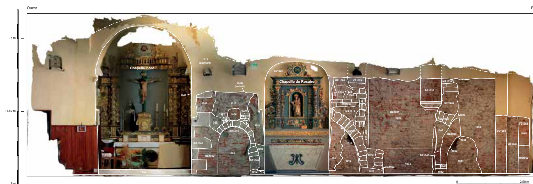
Figure 1 : Vue d'ensemble du mur oriental de la nef portant l'ensemble des vestiges identifiés toutes périodes confondues, depuis le sud (orthophotographie A. Farge, DAO R. Fritz, Inrap).
