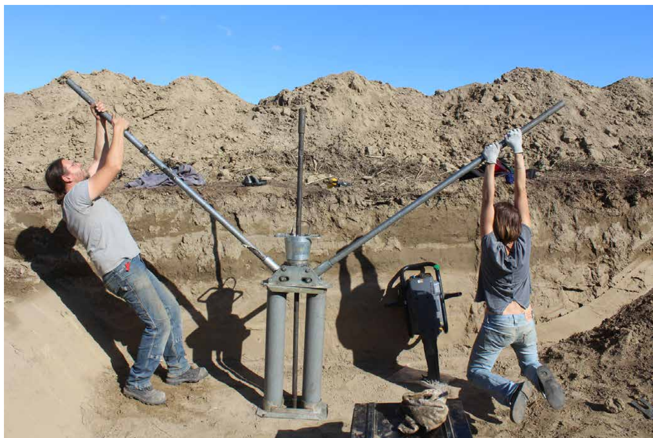
Figure 4 : Remontée manuelle d'une carotte sédimentaire (cliché : SAD.66)
