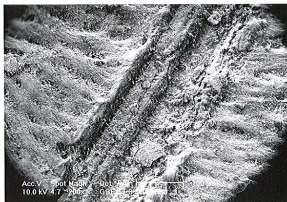
Strie observée au microscope électronique à balayage (cl. B. Deniau)
